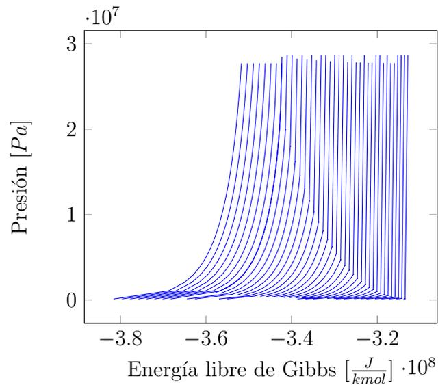
**Figura 5.10:** *Diagrama de la energía libre de Gibbs para el agua. Las líneas azules representan isotermas. Nótese el cambio en las pendientes de las líneas isotermas, este cambio indica un cambio de fase.*
