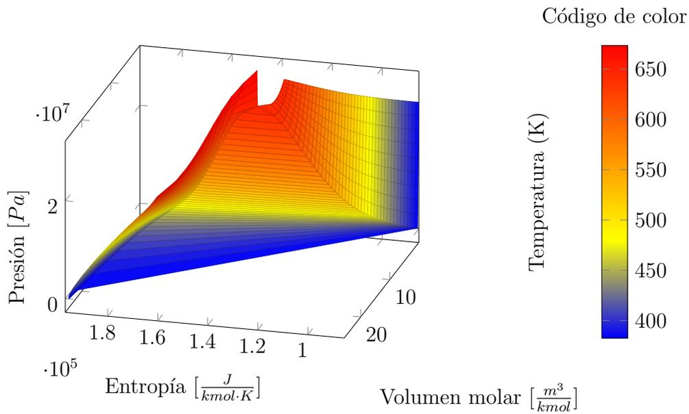
**Figura 5.9:** Diagramas tridimensional presión-entropía-‘volumen molar’ para el agua.
