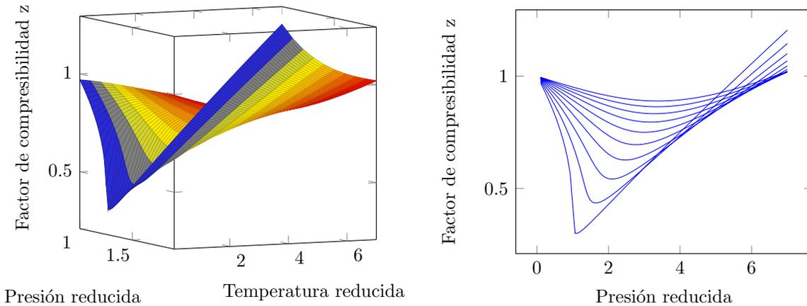
**Figura 5.3:** *Izquierda: Diagrama tridimensional 'factor de compresibilidad'- 'presión reducida'- 'temperatura reducida'. Derecha diagrama del factor de compresibilidad contra presión reducida. Ambas figuras creadas con la ecuación de estado de Van Der Waals para el heptano*
