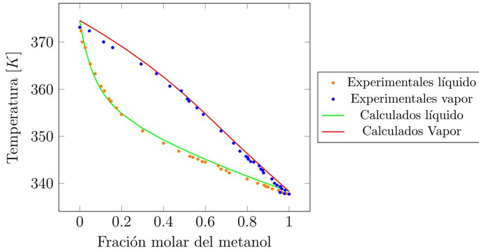
**Figura 5.21:** Diagrama temperatura-fracción molar para el sistema agua-metanol, con la ecuación PRSV, parámetro binario  $k_{ij} = -0.0739981$ , parámetros de  $\alpha$ : Metanol  $k = -2.7 \cdot 10^{-5}$ , Agua  $k = 0.009276$
