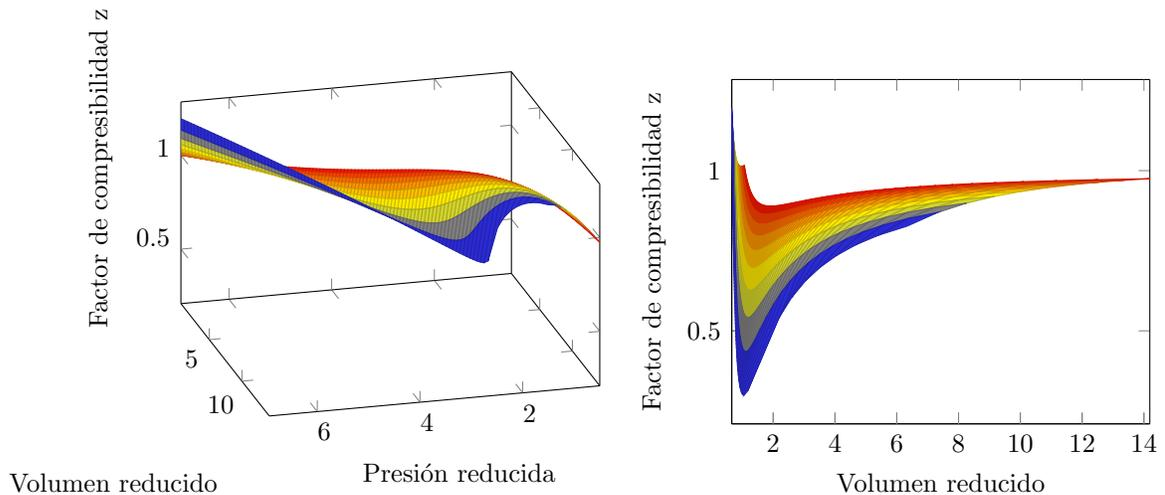
**Figura 5.4:** Izquierda: Diagrama tridimensional 'Factor de compresibilidad'-'volumen reducido'-'presión reducida'. Derecha: 'Factor de compresibilidad'-'volumen reducido'. Ambas figuras calculadas con la ecuación de Van Der Waals para el heptano
