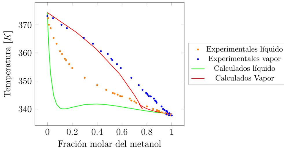
**Figura 5.20:** Diagrama temperatura-fracción molar para el sistema metanol-agua, con la ecuación PRSV y la regla de mezclado de Van Der Waals. Los parámetros de la expresión de alfa para los compuestos es igual a cero, y también los parámetros binarios de la regla de mezclado
